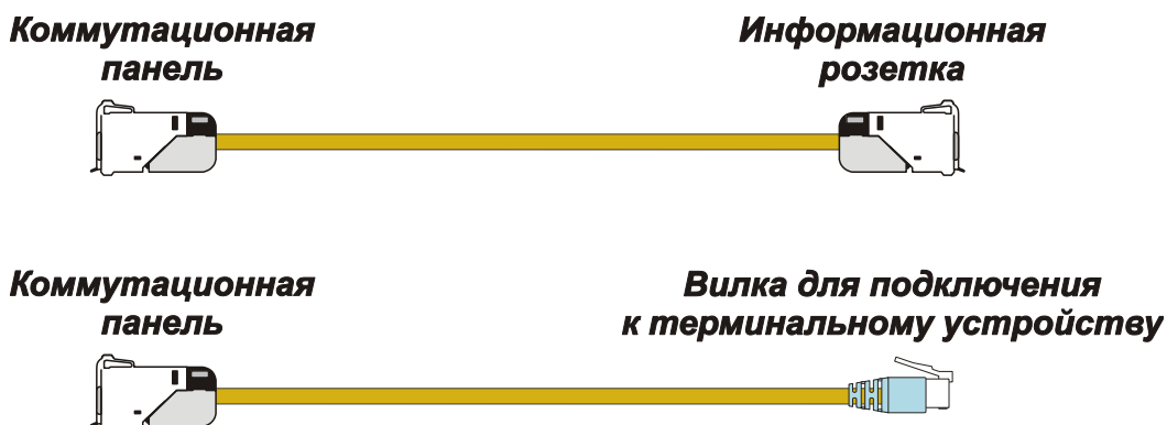
Варианты организации стационарных линий: вверху классическая, внизу direct connection
